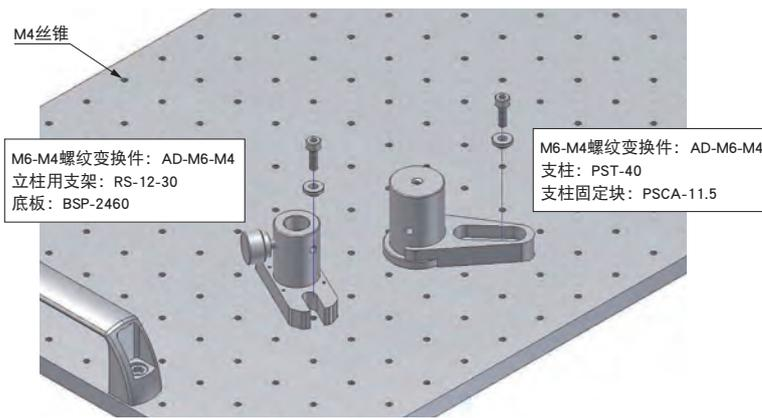
使用M6-M4螺纹变换件AD-M6-M4面包板（例：在OBC-3045）固定。
